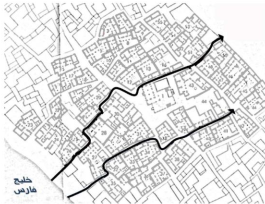
تصویر ۵: لافت - چگونگی استقرار ساختمان‌ها عبور باد را میسر می‌کند
