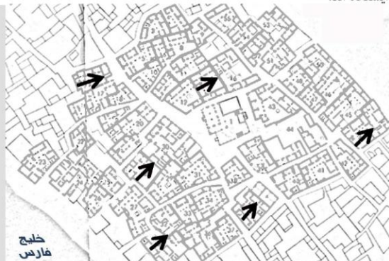
تصویر ۷: لافت - جهت‌گیری بناها در راستای شمال شرقی - جنوب غربی برای دریافت گرمای کمتر و کوران بیشتر
